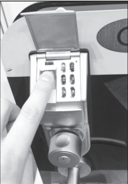
Spyna atsirakina nuskanavusi piršto atspaudą. Įrenginys įsimena ir atpažįsta iki 150 skirtingų pirštų atspaudų.
